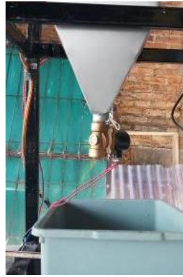
Gambar 17. Pengujian Selenoid Valve tertutup
