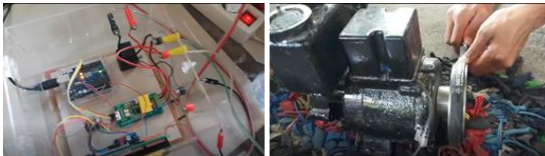
Gambar 22. Pengujian Monitoring Arus Motor Pada PZEM
