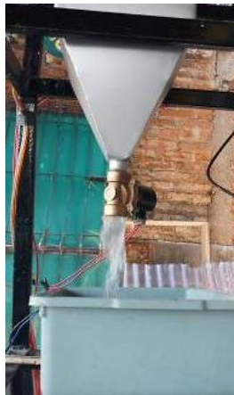
Gambar 18. Pengujian Selenoid Valve terbuka
