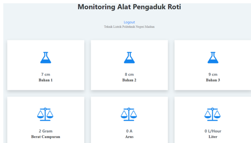
Gambar 20. Pengujian Keseluruhan Sistem pada Halaman Website
